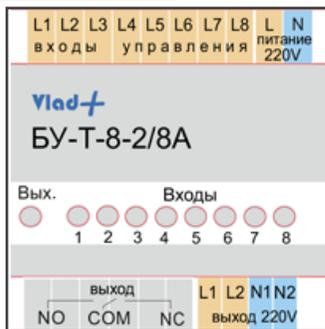
Данный блок позволяют включать насос смесительного узла и котел при наличии запроса на тепло от термостата хотя бы по одной из 8-ми зон и, соответственно, выключать это оборудование при отсутствии таких запросов. Блоки имеют встроенный таймер задержки - 3 минуты, необходимой для открывания сервоприводов. Задержку можно деактивировать, сняв перемычку на плате.
