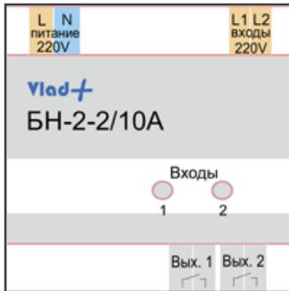
Данные блоки позволяют подключить к слаботочным входам 220В более мощных нагрузок. Например, к выходам центра коммутации, рассчитанного для управления максимум 3-4 сервоприводами, необходимо подключить циркуляционные насосы или нагревательный кабель электрического теплого пола. Одно такое устройство позволяет произвести сопряжение нагрузки по 2-м каналам (зонам).
